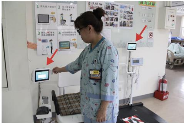
圖說：病人量完體重，數值即可透過坐式體重機上的傳輸機（如紅色箭頭所示），登錄在「電子化透析管理系統」裡。圖/東基結金球提供
